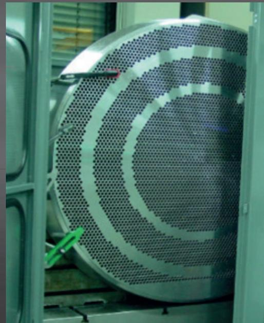
Application : mouliste, forage  $\varnothing$  22.00 mm avec trous en biais
