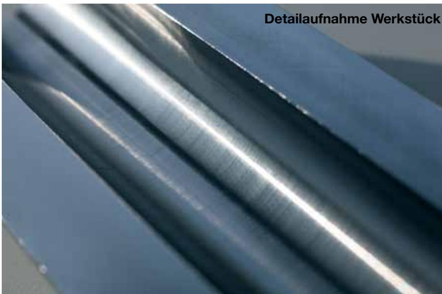
Bild 7: Das Oberflächenbild zeugt von der Qualität der Bohrung (Werkbilder: botek Präzisionsbohrtechnik GmbH, Riederich)
