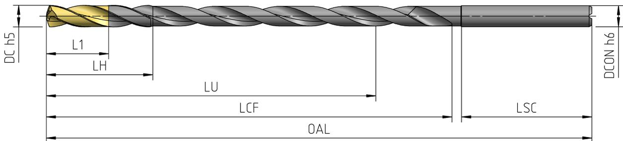
Typ 158-00 Spiralisierter Tieflochbohrer (Hochleistungs-Spiralbohrer) in Vollhartmetall-Ausführung **4-Fasen** mit Innenkühlung, Spitzenwinkel 140°
