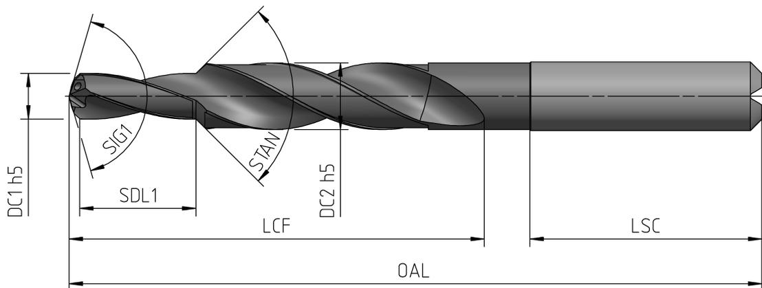
Typ 154-02 Vollhartmetall-Stufen-Pilotbohrer ohne Innenkühlung / Spitzenwinkel 140° (SA0174), 3 x D (Spannutlänge) - **in Standardausführung bzw. Sonderanschliff auf Wunsch**
