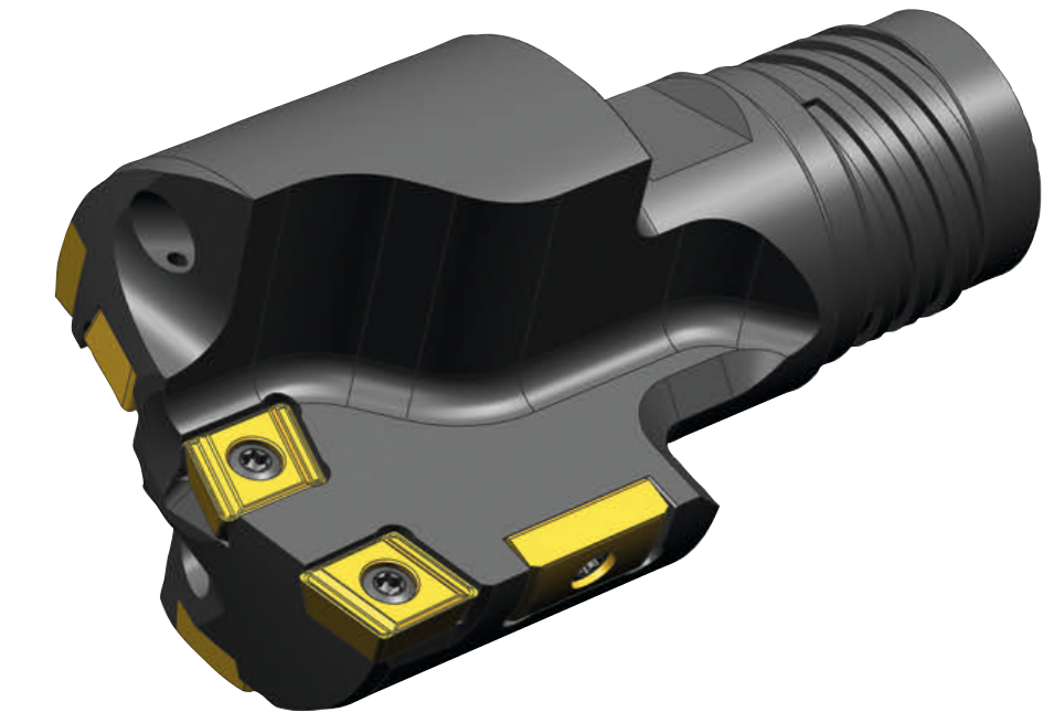
1 Das Vollbohrwerkzeug Typ 07A mit Innenkühlung von Botek ist im Zusammenspiel mit einer separaten KSS-Zuführung für Bohrungen bis 50 \times D ausgelegt
